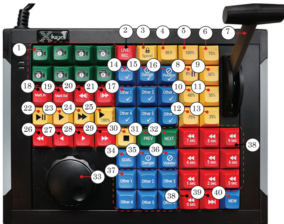
Пульт X-keys XK-64. Управляющие элементы:
